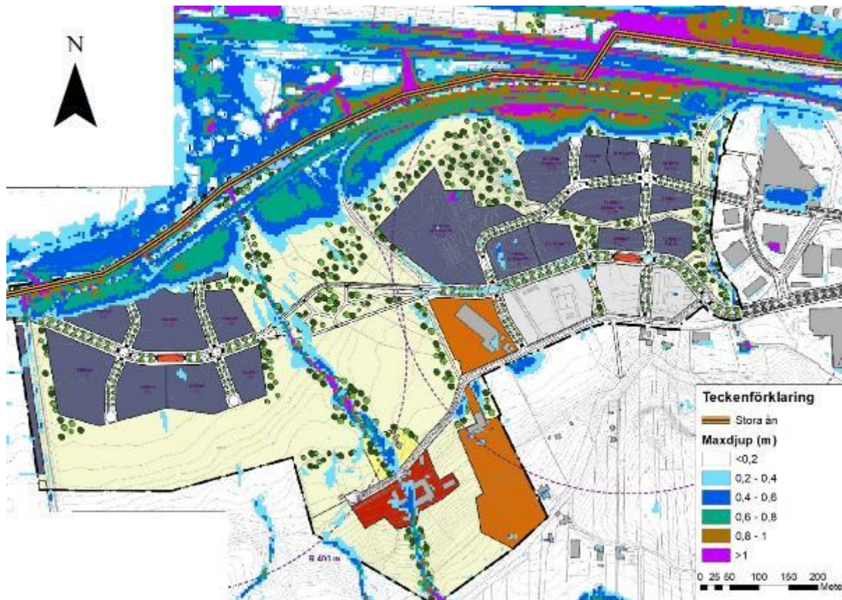
Figur 8.14 Beräknat vattendjup vid ett klimatanpassat 100-årsregn (100-årsregn) med DHIs beräknade flöden i Stora Ån, som randvillkor vid ett 10-årsregn vid befintlig situation (Sweco 2020a).
