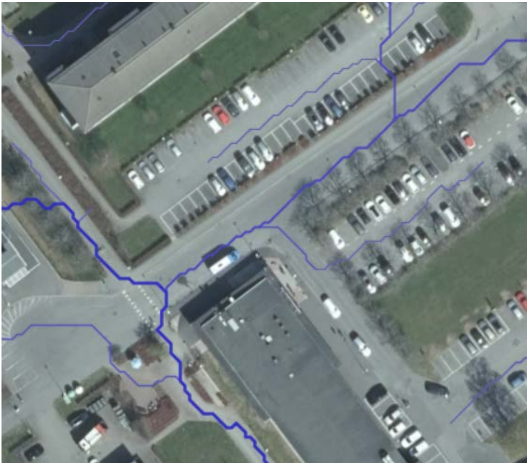
Figur 21. Befintliga rinnvägar, Pinnharvsgatan.
