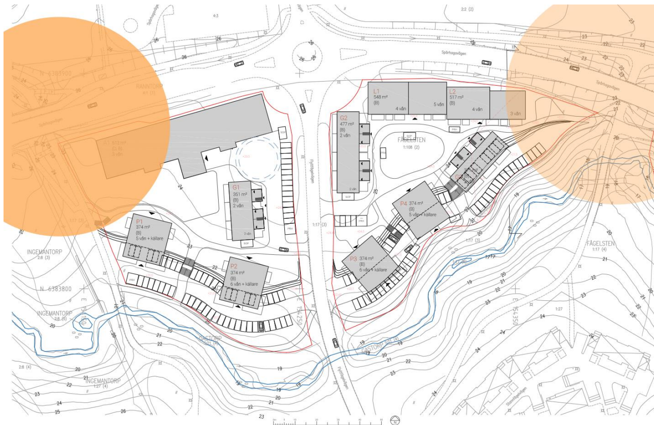
Figur 6.1. Riskområde med förutsättning att vibrationsalstring sker i närheten av mätpunkt 1 och uppmätta vibrationsnivåer i denna mätpunkt.
