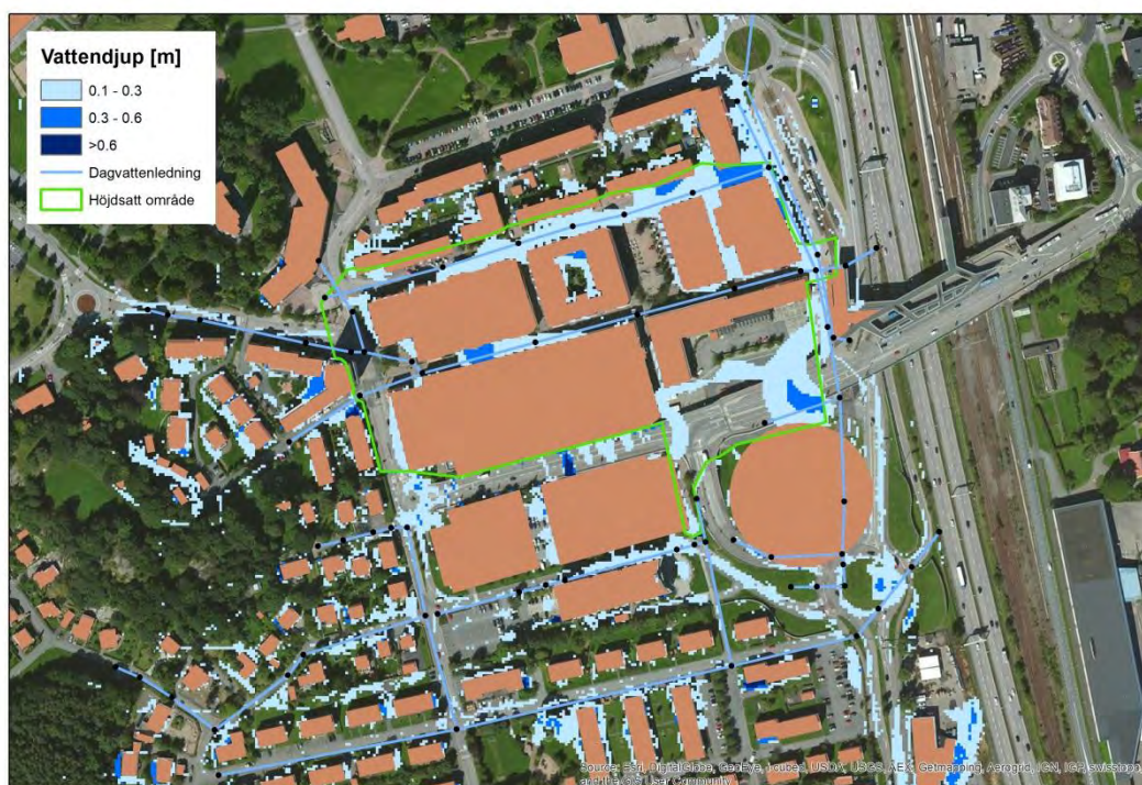
Figur 5.2-3. Översvämningsutbredning 200-årsregn och normal nivå i Mölndalsån, med reviderad höjdsättning och hänsyn tagen till all ytavvattning. Figuren visar maximala erhållna vattendjup under hela den studerade regnhändelsen.
