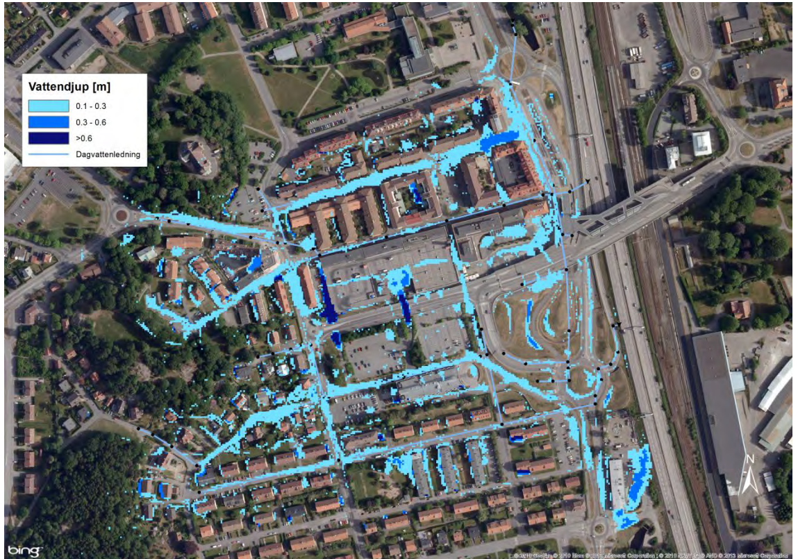
Figur 4.3-1 Översvämningsutbredning 200-årsregn med normal nivå i Mölndalsån, med hänsyn tagen till all ytavvattning. Figuren visar maximala erhållna vattendjup under hela den studerade regnhändelsen. En förstora bild finns även i Bilaga C.
