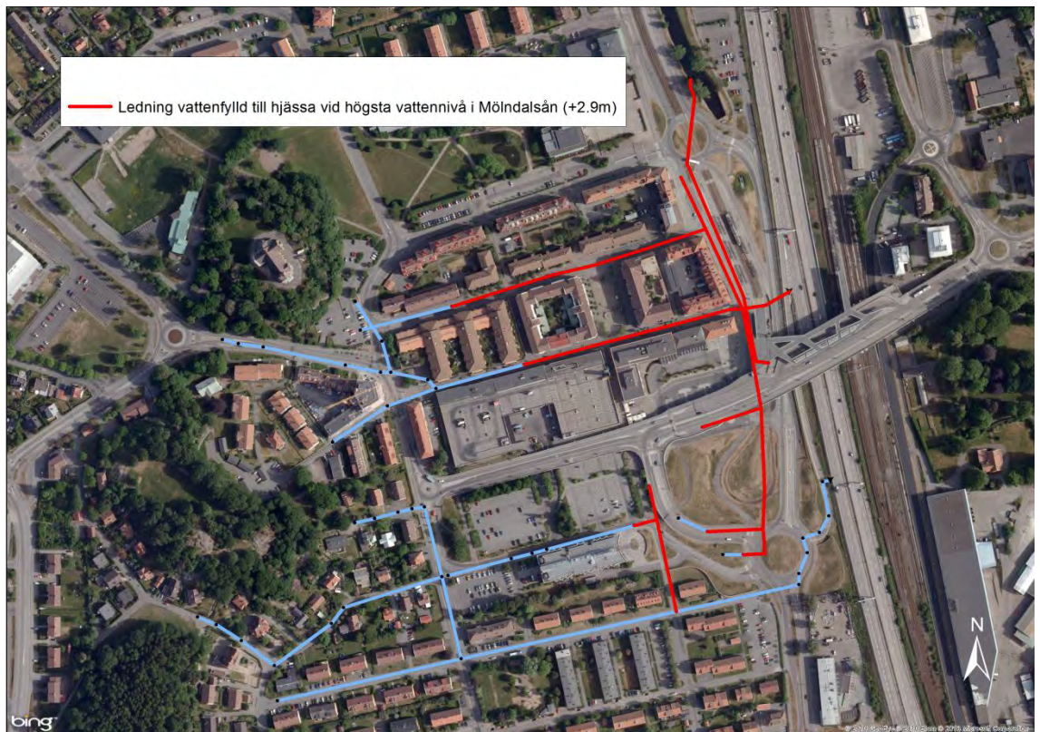
Figur 4.5-1 Dämda ledningar fyllda till hjässan vid högsta nivån i ån, utan bakvattenventiler.
