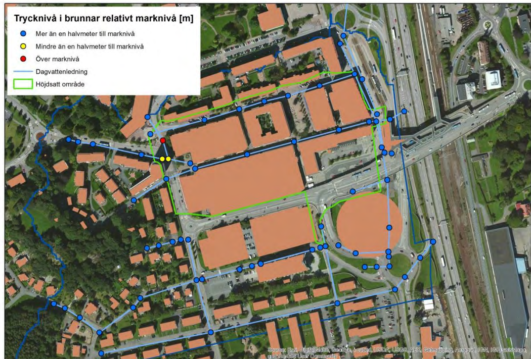
Figur 5.2-4 Översvämmade brunnar vid kontrollberäkning av ledningsnätets kapacitet med ett dimensionerande 10-årsregn.
