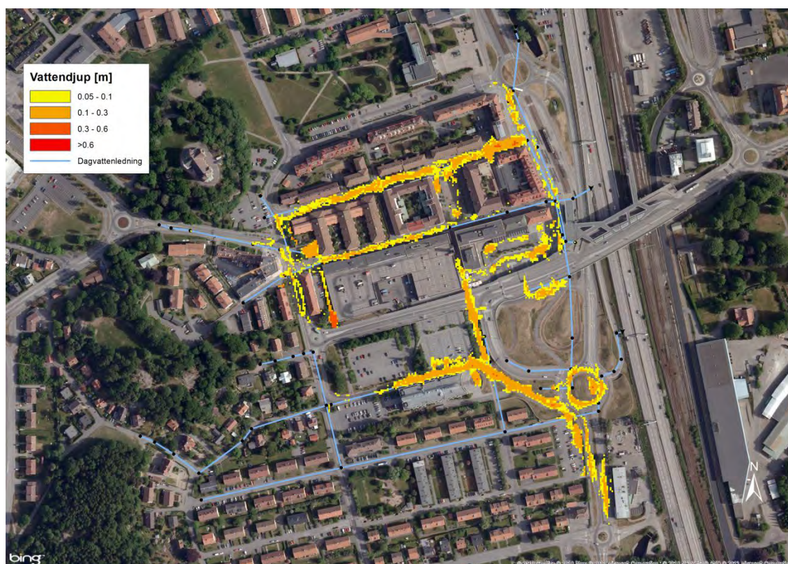
Figur 4.2-1 Översvämningsutbredning 200-årsregn med normal nivå i Mölndalsån. En förstord bild finns även i Bilaga B.
