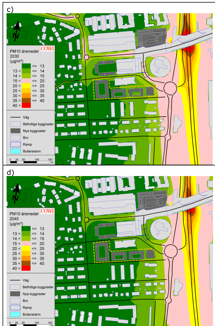
Figur 10. Beräknade halter av årsmedelvärdet av \text{PM}_{10} ( \mu\text{g}/\text{m}^3 ) för a) nuläget, b) år 2022, c) år 2030 och d) år 2040. Planområdet är markerat med orange streckad linje. Områden med en höjd över 4,5 meter jämfört med planområdet har gråmarkerats.
