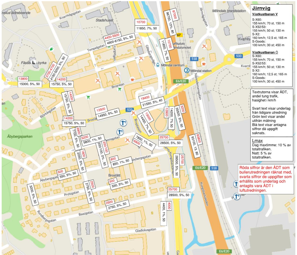
Figur 4. Trafikunderlag för framtida trafik år 2030. Svarta trafiksiffror visar ÅMVD. Röda siffror är ett senare tillägg som visar den ÅDT som bullerutredningen (ÅF Infrastructure AB 2019) använt för samma vägavsnitt. Andelen tung trafik är 5 % på kommunala vägar och 13 % på E6 år 2040.
