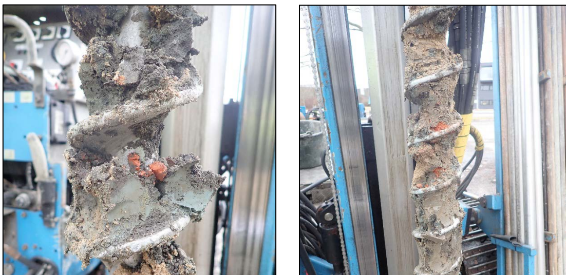
Figur 3. Exempel på inslaget av tegel i fyllnadsmaterialet i punkt 1805 och 1806.
