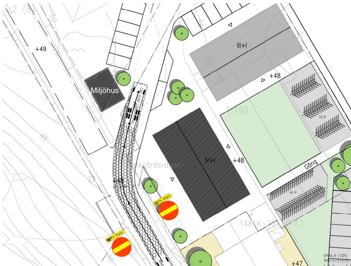
Figur 9 Illustrationen visar föreslagen placering av miljöhus och körspår för sophämtning. Byggnadernas placering har justerats något efter denna illustration, men på ett sätt som inte bedöms påverka framkomligheten negativt.
