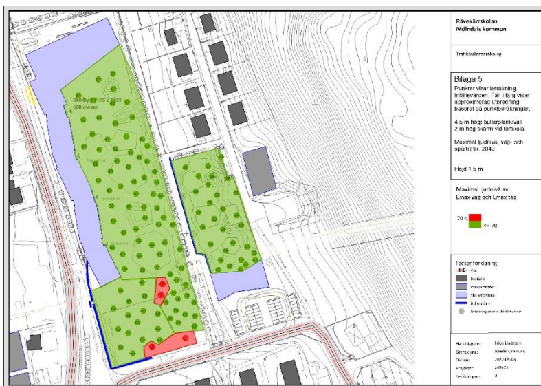
Maximal ljudnivå med ny byggnadsutformning och 4,5 meters bullerskärm i plangräns samt 2 meters bullerskärm vid förskolegårdens västra sida. Grönt område visar mindre än 70 dB ljudnivå, rött visar över 70 dB ljudnivå.
