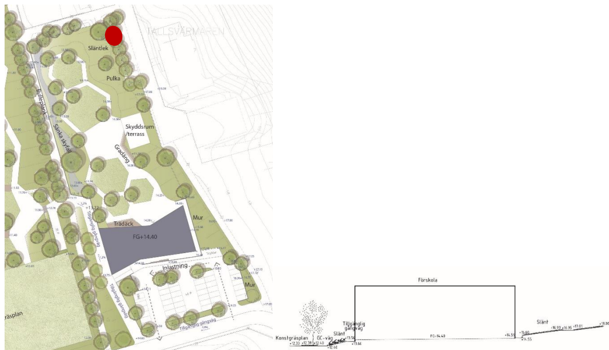
Illustrationsplan över förskoleområdet och en sektion genom förskolebyggnaden med slänt och gång- och cykelväg på båda sidor om byggnaden. Den röda pricken på illustrationsplanen visar transformatorstationens nya läge.
